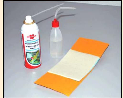
*Zur Reinigung benötigen Sie Optikpapier, Druckluft und Isopropanol.*
